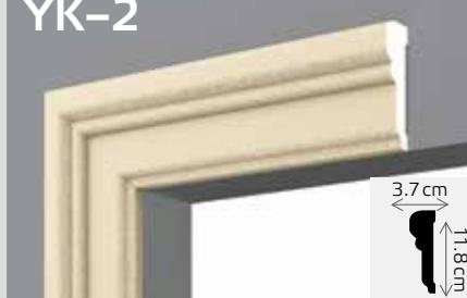
Fasadne lajsne su proizvedene od ekspandiranog polistirola koji je premazan hidroizolaconim zaštitnim premazom, što im daje otpornost prema atmosferskim uticajima. Ovaj premaz je fleksibilan, paradifuzan, tvrd, otporan prema UV zracima i vlazi. Ne skuplja se.
