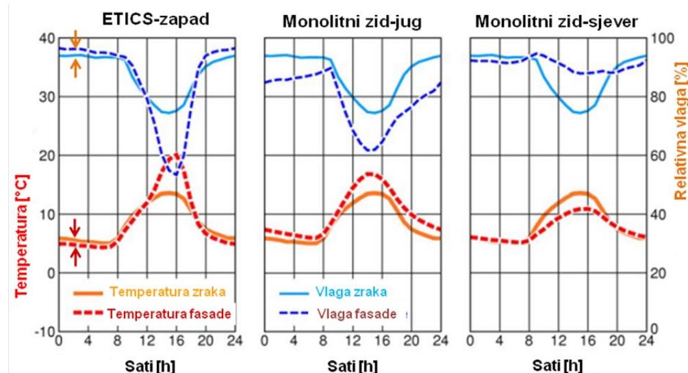
Hlađenjem noću temperatura površine ETICS-a pada ispod temperature zraka. Zapadno orijentirani zid ujutro se vrlo sporo zagrijava, a temperaturna rošta okolnog zraka raste i može dovesti do jake kondenzacije na hladnom zapadnom pročelju.
