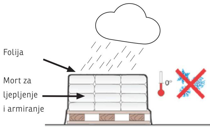
**Slika 11:** Zaštita ziđa od vlaženja tijekom gradnje
